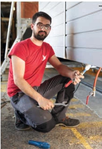
El circuito de agua se instala bajo el chasis en las primeras etapas de fabricación. A continuación se conectan el fregadero, la ducha, el inodoro y la caldera. Como última fase de la instalación, efectuamos tests de gas y de agua para comprobar que los circuitos funcionan correctamente.
